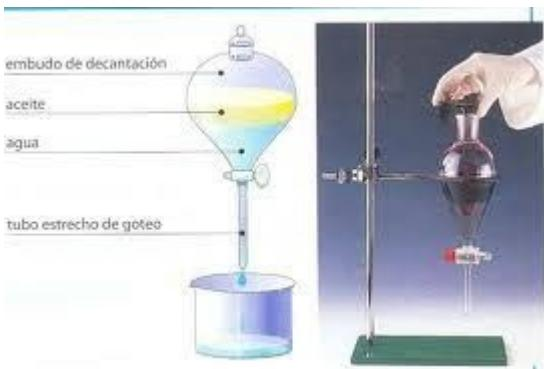
Para分离 los componentes de una mezcla de líquidos de diferente densidad que no se mezclan –como el agua y el aceite–, se utiliza el método de **decantación**, y el dispositivo que se necesita se llama ampolla de decantación. Puede hacerse siempre y cuando exista una diferencia importante entre las densidades de las fases. Se deja reposar la mezcla y estas se separan solas. Luego, se drena la que ha quedado en la parte inferior de la ampolla de decantación.
